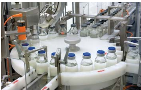
Укупоривание флаконов с иммуноглобулином для в/в введения на одной из четырёх линий розлива на заводе в Берне
